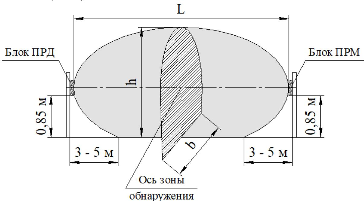
Рисунок 1.1 – Конфигурация зоны обнаружения, формируемая извещателями, установленных на опорах
